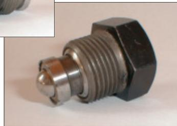
geölte Schraube mit mechanischer Funktion muß in allen Bereichen mit Ausnahme des Kopfes garantiert lackfrei bleiben. Die mechanische Funktion muß nach der Beschichtung gewährleistet
