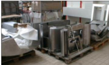
Die Rohware ist im Haus. Sie wird entfettet, phosphatiert, getrocknet und mit einem speziellen Füllprimer grundiert. Danach geht's in die Abteilung "Schleifen".
