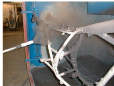
Restaurationen werden grundsätzlich manuell beschichtet. Nur so läßt sich sicherstellen, daß auch in kritischen Bereichen ausreichend dicke Schichten aufgetragen werden und der Verlauf der fertigen Oberfläche schön glatt ausfällt.
