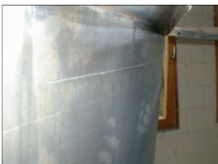
Deutlich sichtbar tiefe Kratzer von der Blechbearbeitung. Nach der Beschichtung wären diese noch besser sichtbar. Bei anspruchsvollen Teilen muß so
