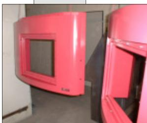
Fertigteile der gleichen Verhaubungsserie hängen zur Montage bereit.
