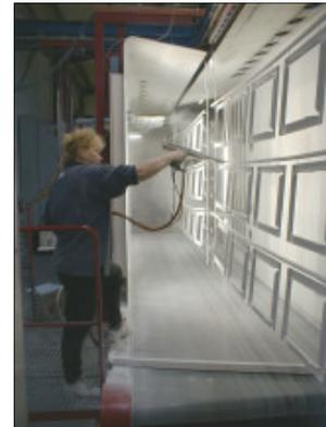
In der Pulveranlage wird automatisch beschichtet, problematische Bereiche werden von Hand nachgearbeitet. Es folgt der Pulvertrockner, in dem die Beschichtung vernetzt wird und danach wieder eine Kühlstrecke.
