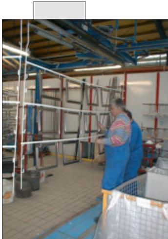
Die in Gitterboxen angelieferten Türen und Rahmen werden auf Gehängen platziert und laufen dann an sogenannten Traversen hängend durch die verschiedenen Prozessstufen. Zuerst geht's durch die 7-stufige Waschmaschine, dann in den Haftwassertrockner, durch die Kühlstrecke und in
