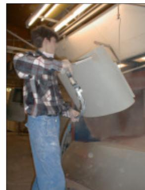
Hier wird die Finishschicht aufgetragen und dann bei 195 Grad im Pulvertrockner vernetzt.
