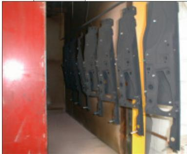
Grundierte Automobilkarosserieteile laufen in den Pulvertrockner ein. Alle Gewinde sind maskiert. Vernetzungsbedingungen:
