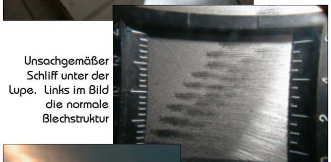
Unsachgemäßer Schliff unter der Lupe. Links im Bild die normale Blechstruktur
