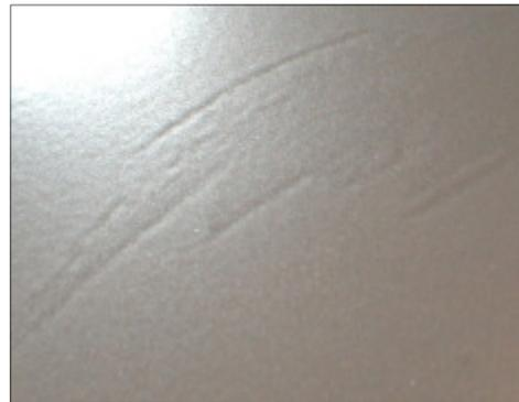
Silikonkontaminiertes Blech nach der Beschichtung. So oder auch kraterförmig zeigen sich Verlaufsstörungen durch Silikon.
