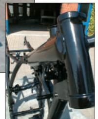
Das Ergebnis: Ein Rahmen wie neu - oder besser? In diesem Fall in Schwarz seidenmatt endbeschichtet. Glatter Verlauf, alle kritischen Bereiche, Hinterschnidungen etc. ausreichend dick beschichtet, eine sehr resistente Alternative zur Naßlackierung.
