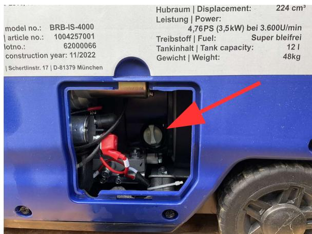
Abbildung 18: Öleinfüllstutzen
