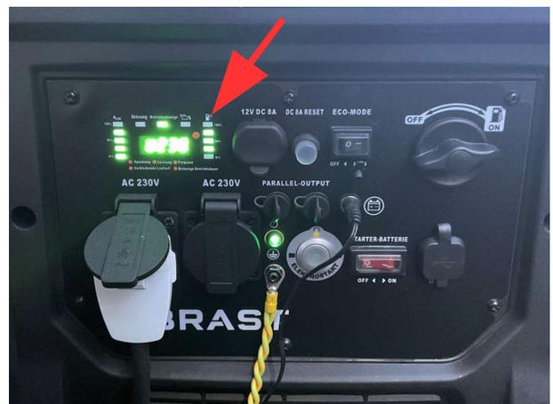
Abbildung 19: Benzinfüllstandsanzeige am Generator
