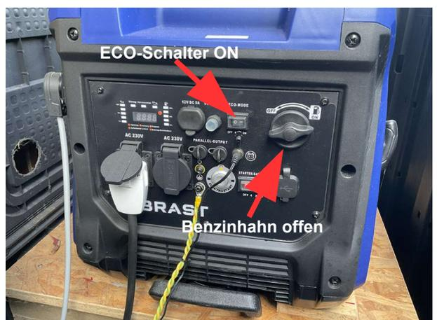
Abbildung 4: Eco-Schalter und Benzinhahn
